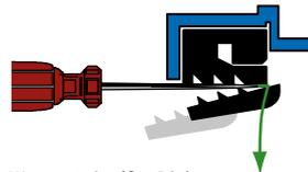
Wenn nötig (für Dichtbereich 2), inneren Dichtring rundherum lösen und entfernen.
