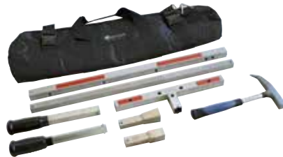
Der Schieberschlüssel ist komplett zerlegbar und passt inklusiv allen Zubehörteilen in die handliche Tragtasche.
