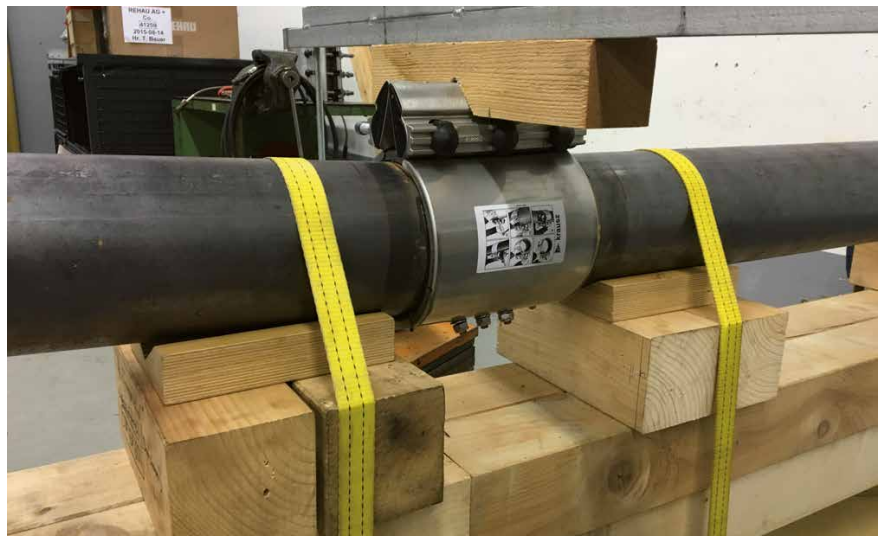
Im SKZ-Testlabor: Unter anderem Prüfung der Dichtheit bei 29 bar positivem Innendruck und 3° Auswinkelung.
