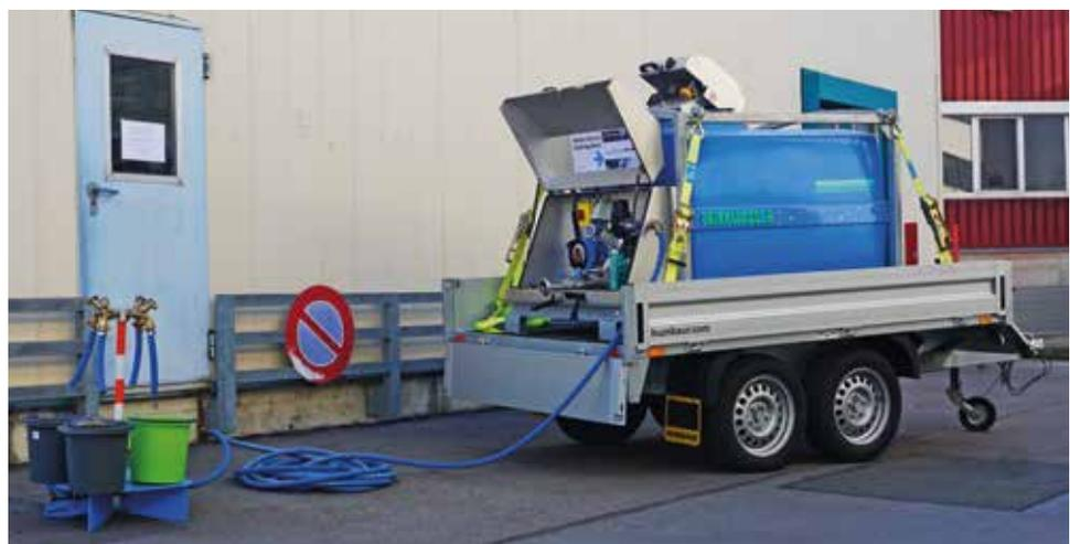
ALVEUS, nach DVGW/KTW geprüfter Transport- und Versorgungsbehälter für Trinkwasser im Einsatz.
