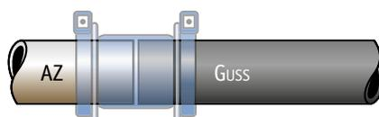
Verbindungen AZ mit Guss oder PE
