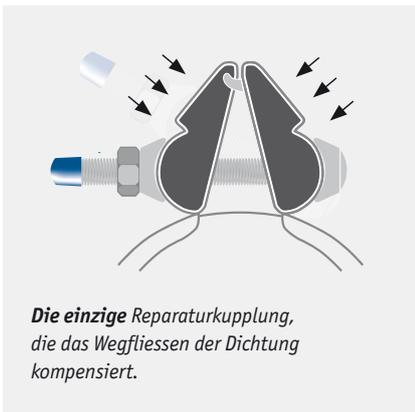
Die einzige Reparaturkupplung, die das Wegfließen der Dichtung kompensiert.
