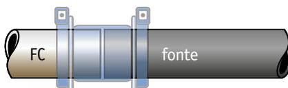
Raccords FC avec tube en fonte ou PE
