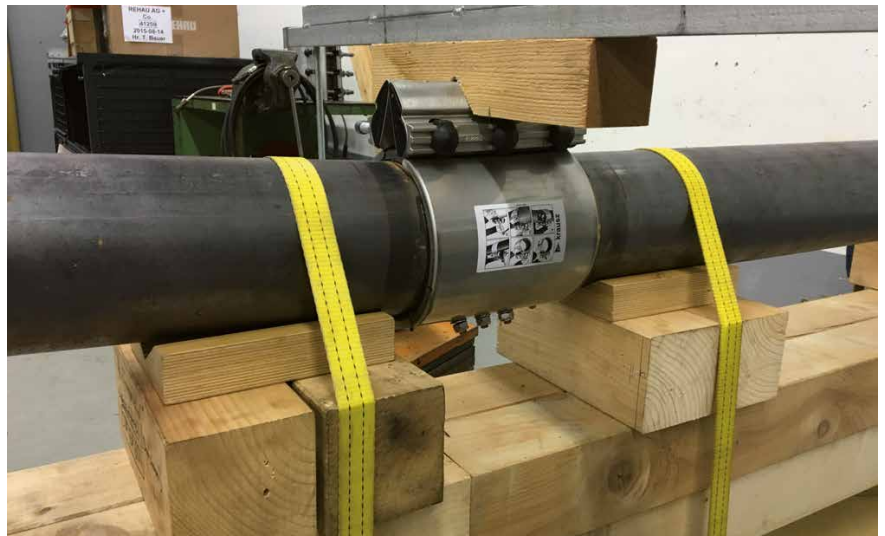
Dans le laboratoire d'essai SKZ: Essai d'étanchéité à 29 bar de pression positive intérieure et 3° de déviation angulaire jusqu'à 3° par côté.
