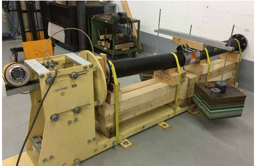
Dans le laboratoire d'essai SKZ: Essai d'étanchéité à 29 bar de pression positive intérieure et 3° de déviation angulaire jusqu'à 3° par côté.
