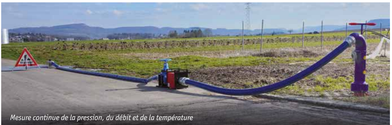
Version DN 80, raccords Storz 75 (autres modèles de DN50-DN150 sur demande)
