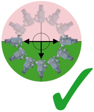
**7** Der Systemtrenner BA-I reagiert auf kleinste Druckschwankungen. Ein leiches Tropfen im Ruhe- und Fließzustand ist bei Druckschwankungen möglich.
