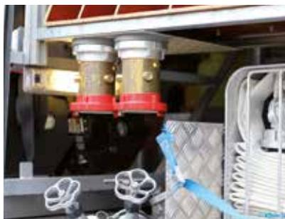
Exemple de montage directement à l'hydrante, rangement dans un véhicule d'extinction
