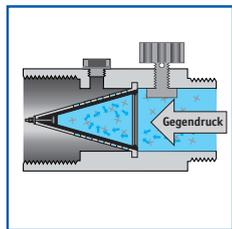
Le système d'étanchéité à membrane conique empêche les retours d'eau.
