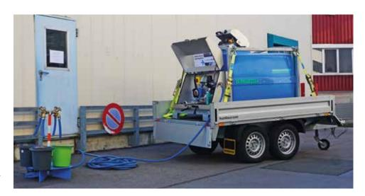
ALVEUS, nach DVGW/KTW geprüfter Transport- und Versorgungsbehälter für Trinkwasser im Einsatz.
