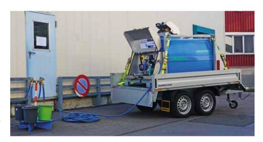
ALVEUS, contenitore per il trasporto e la distribuzione di acqua potabile in uso, testato secondo DVGW/KTW.
