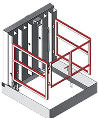
Le garde-corps se met en place automatiquement lors de l'ouverture du LIFTUP.
