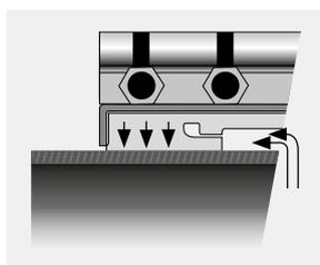
Il giunto di riparazione con tenuta idraulica.
