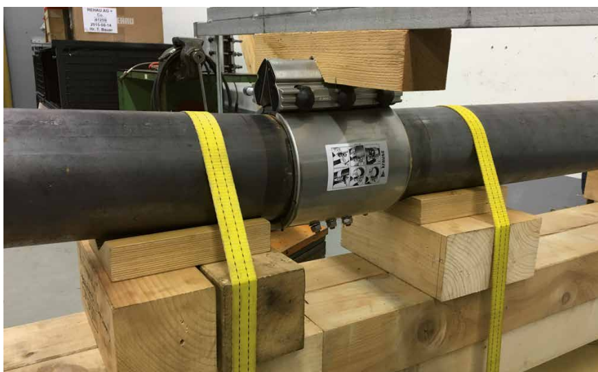
Nel laboratorio di prove SKZ: prova di tenuta con pressione interna positiva a 29 bar e deviazione di 3° per parte.
