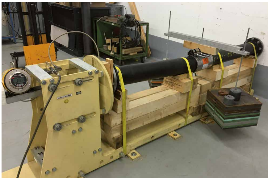
Nel laboratorio di prove SKZ: prova di tenuta con pressione interna positiva a 29 bar e deviazione di 3° per parte.
